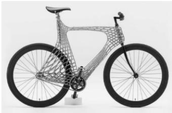
Abb.: Fahrrad in Leichtbauweise aus 3D-Metalldruck<sup>27</sup>
